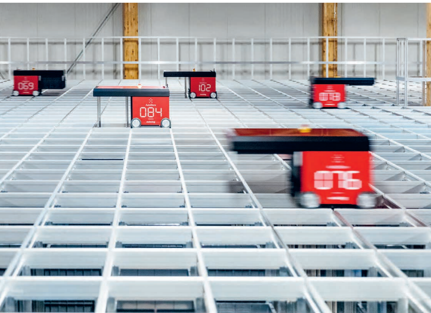
Ein Blick in den Autostore von Sonepar Suisse, Wallisellen: ein modernes und innovatives System zur automatischen Lagerung und Kommissionierung von Kleinteilen
