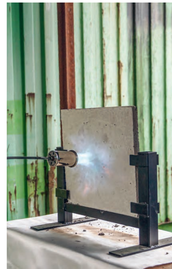
Diese Betonplatte wird erhitzt, um damit Betonabplatzungen im Brandfall zu simulieren
