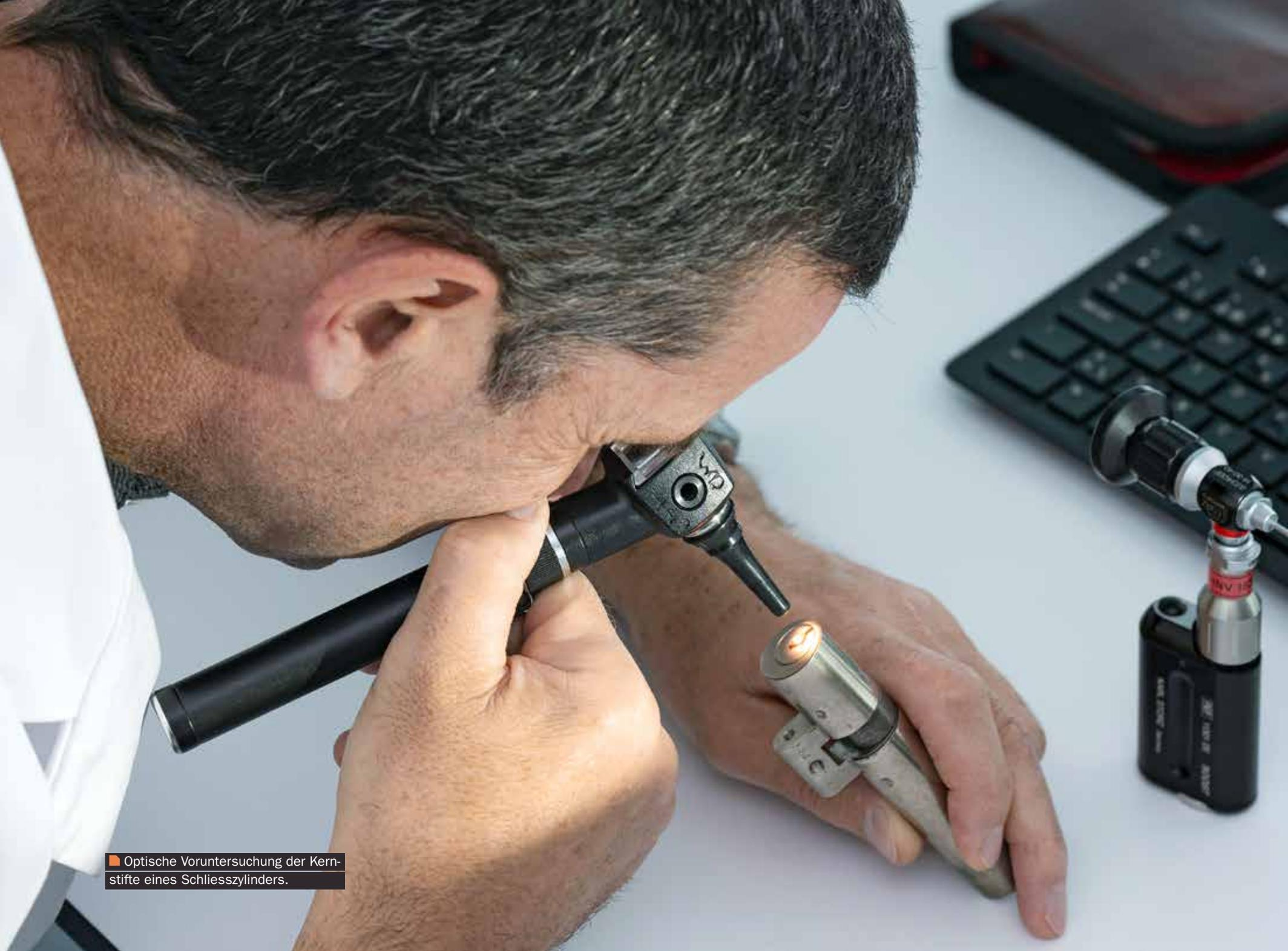
Optische Voruntersuchung der Kernstifte eines Schliesszylinders.
