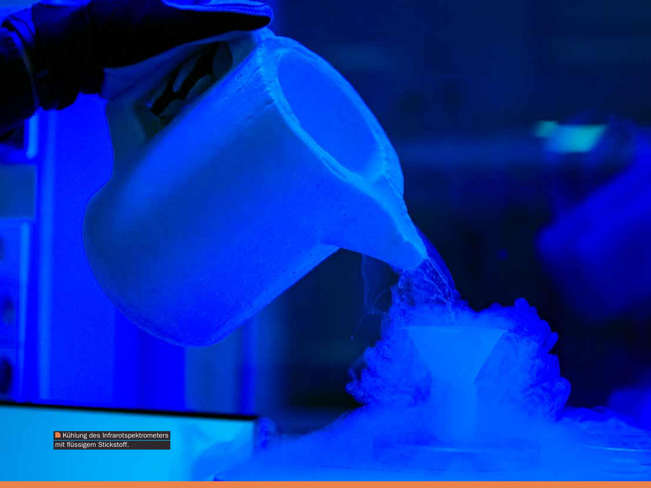
■ Kühlung des Infrarotspektrometers mit flüssigem Stickstoff.
