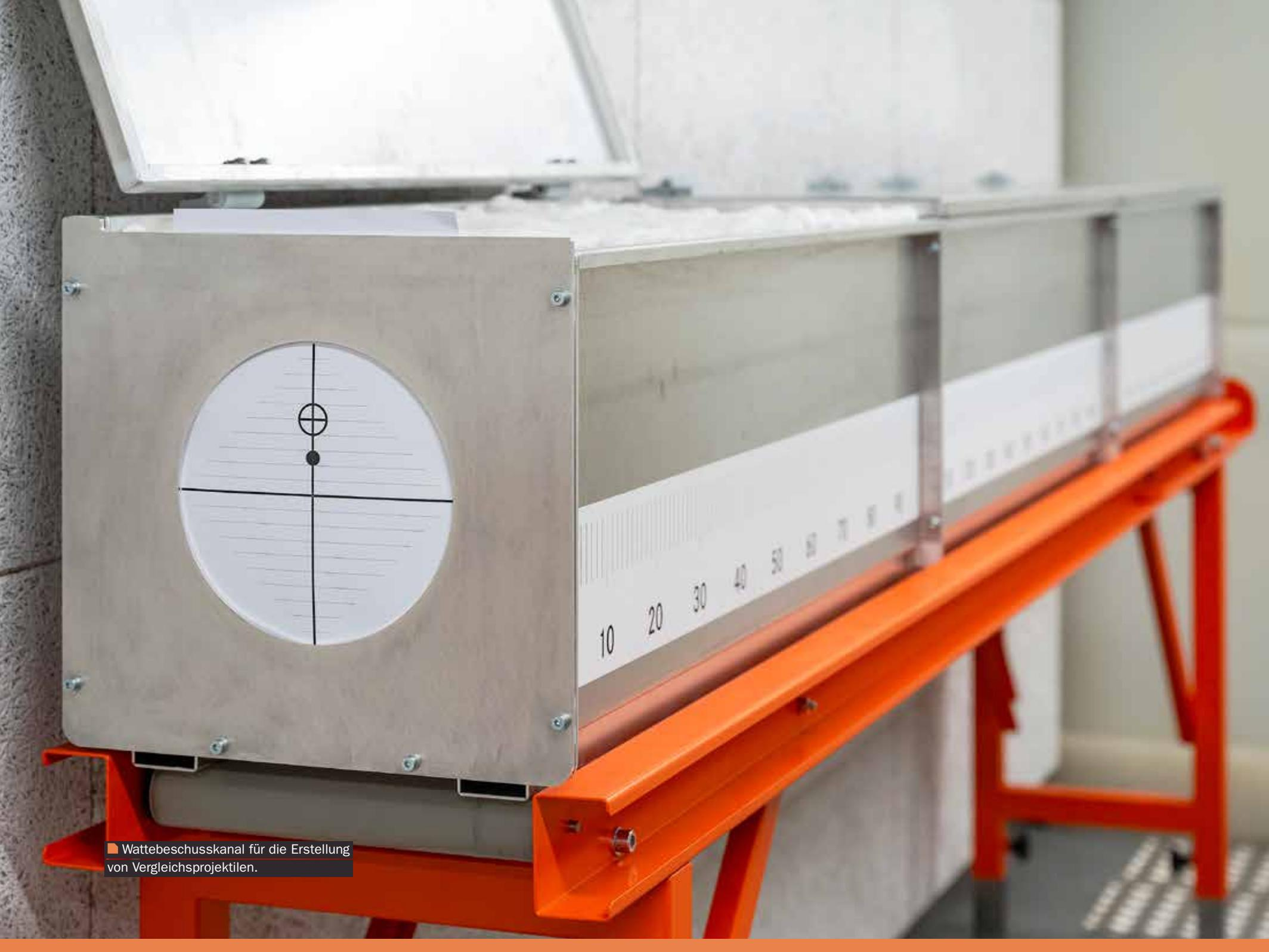
■ Wattebeschusskanal für die Erstellung von Vergleichsprojektilen.
