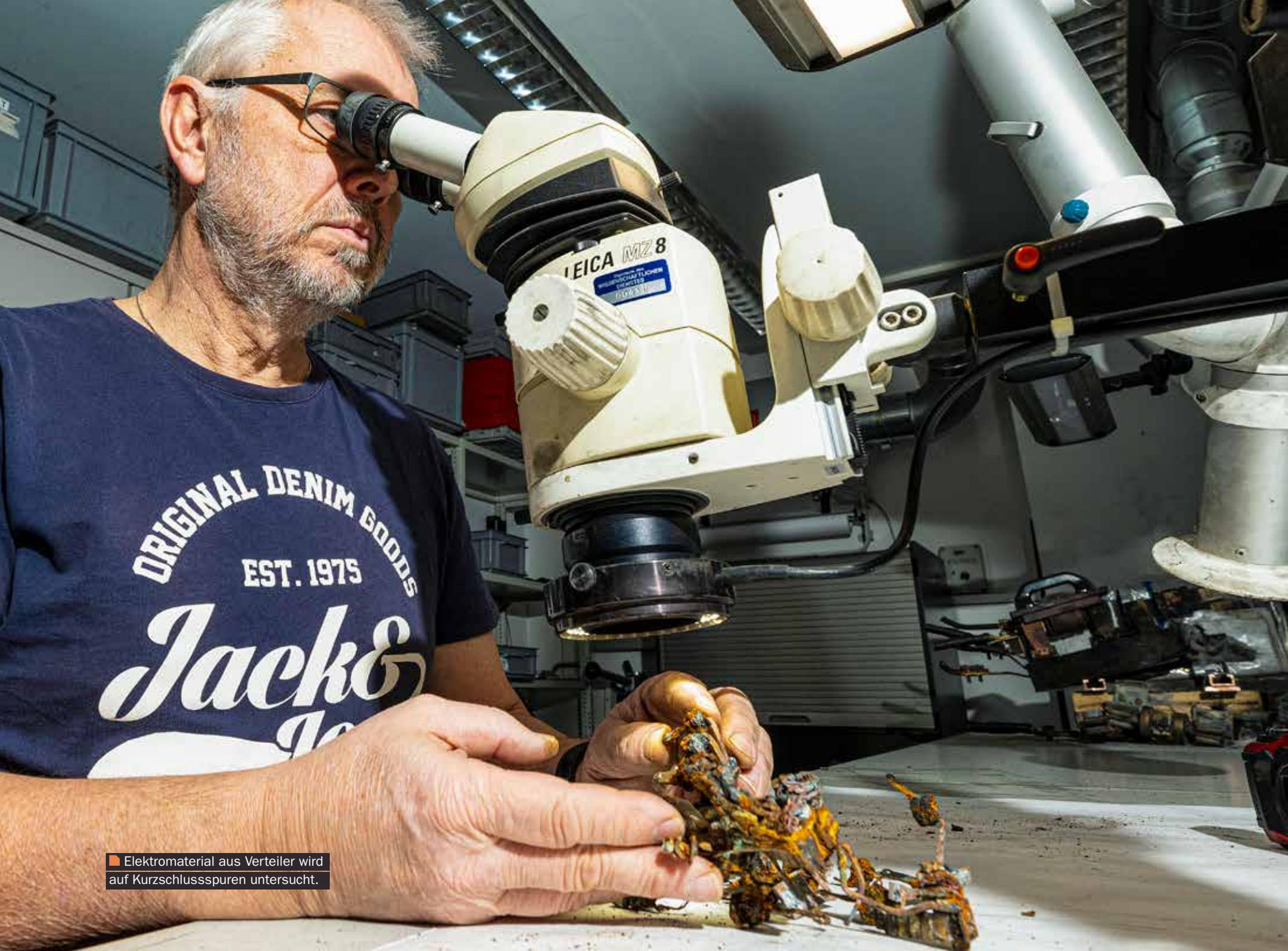
■ Elektromaterial aus Verteiler wird auf Kurzschluss Spuren untersucht.
