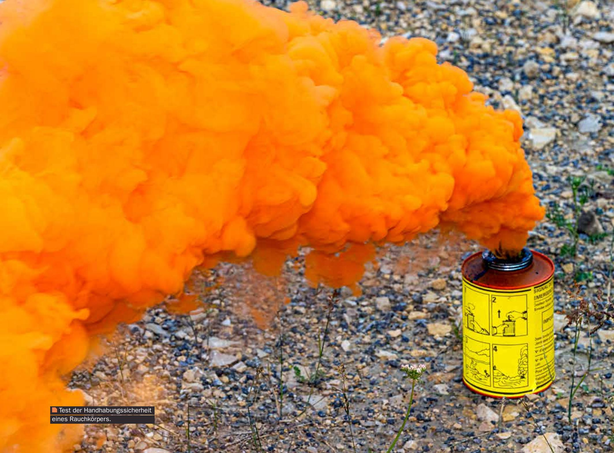
■ Test der Handhabungssicherheit eines Rauchkörpers.
